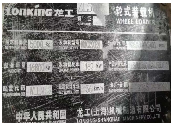
(9)龙工 ZL50C 型装载机(黄色), 识别代码: LSH0050CTDB339858。
